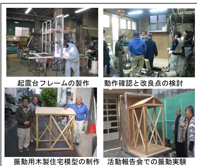
図-8 自作組み立て起震台の製作風景
